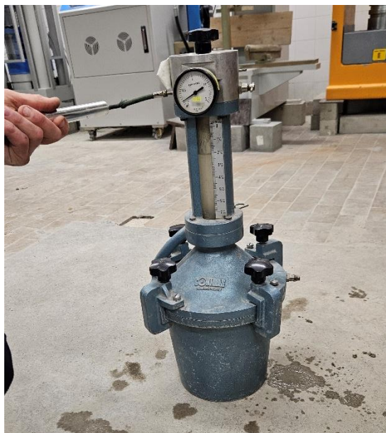
Фигура 2 Определяне на съдържанието на въздух, съгласно БДС EN 12350-7
