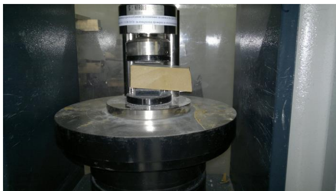
Фигура 2 Изпитване на натиск на пробни тела, от керамични блокчета за настилки
