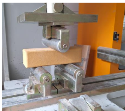
Фигура 1 Изпитване на огъване на пробни тела от керамични блокчета
