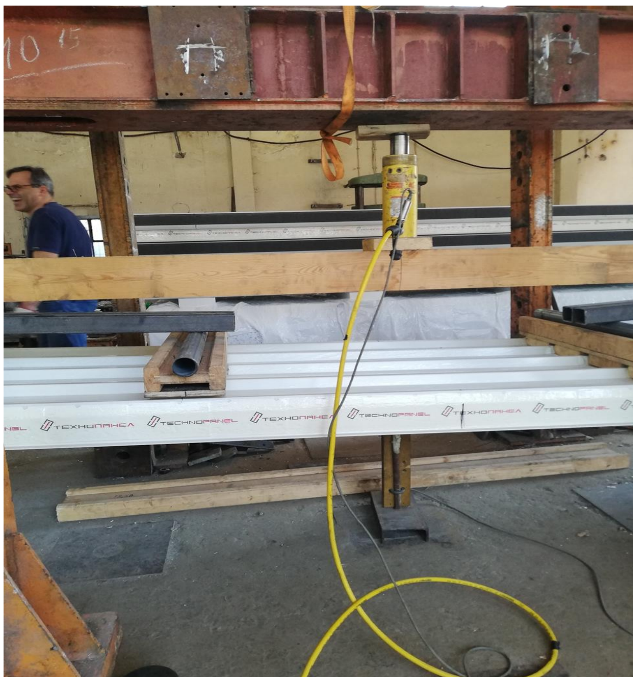
Фигура 3. Изпитване на покривен сандвич панел за определяне на носеща способност при положителни огъващи моменти
