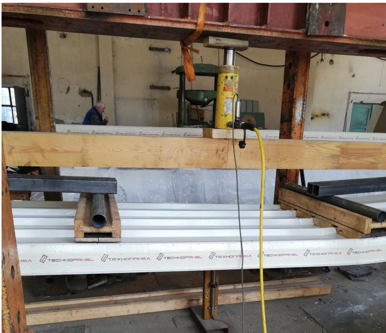
Фигура 4. Настъпване на местно смачкване при изпитване на покривен сандвич панел на огъване
