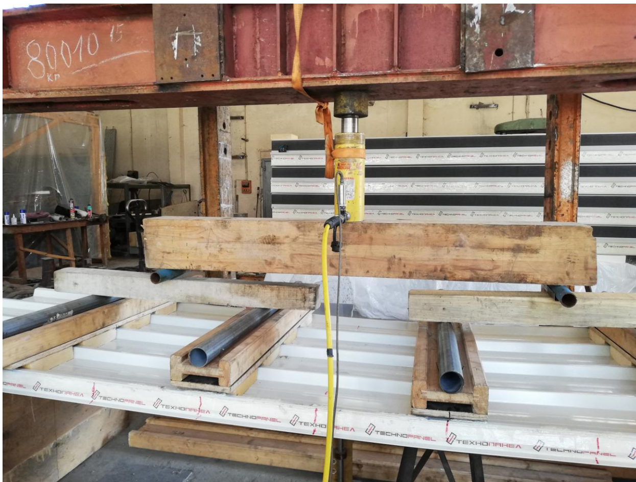
Фигура 4. Изпитване на сандвич панел за определяне на носеща способност при положителни огъващи моменти
