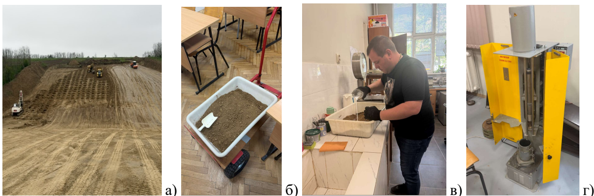
Фиг. 1. Вземане на проба (а) подготовка на проба (б), обогатяване (в) и уплътняване на пробата (г). (фотография А. Zlatarov)
