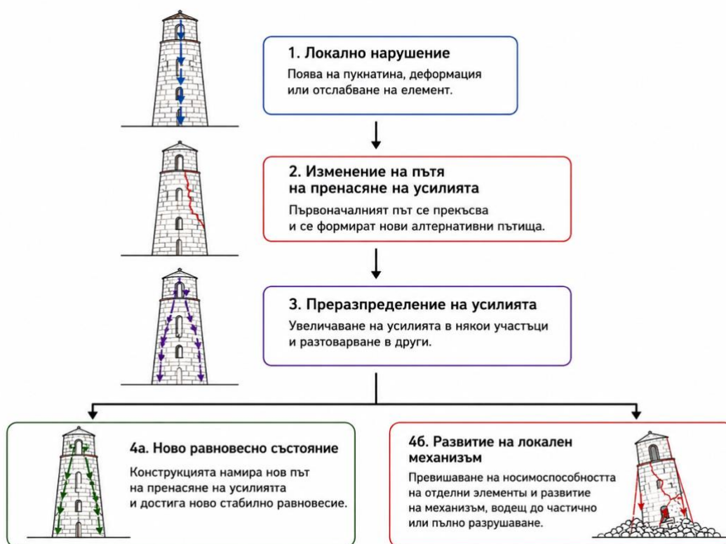
Фигура 1. Последователност на механичните процеси при нарушаване на конструктивната цялост на исторически зидани кули
