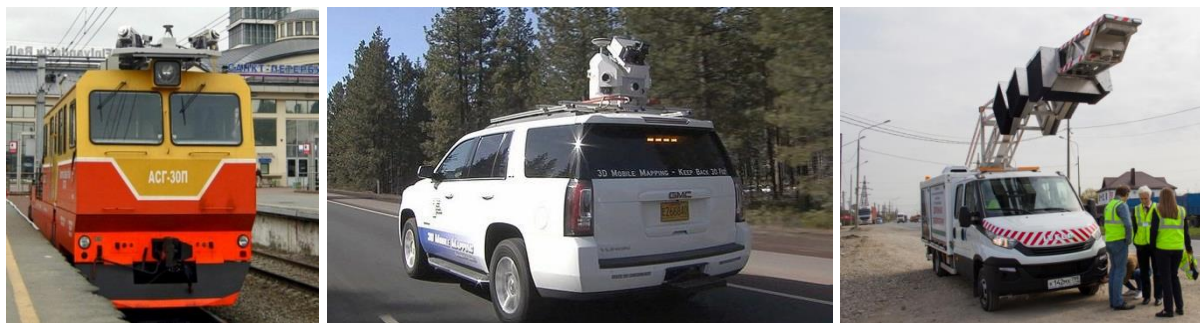
Фигура 1. Лазерен скенер, върху автомобилно шаси, локомотивна мотриси и мобилна лаборатория [3, 4, 5].
