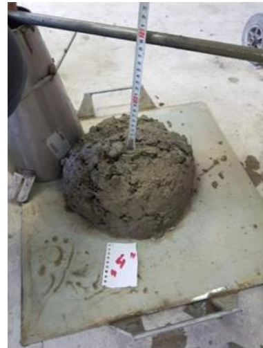
Снимка 6. „4“ MAPEI Dynamon Floor 10; Слягане s = 19,0 cm; w/c = 0,523
