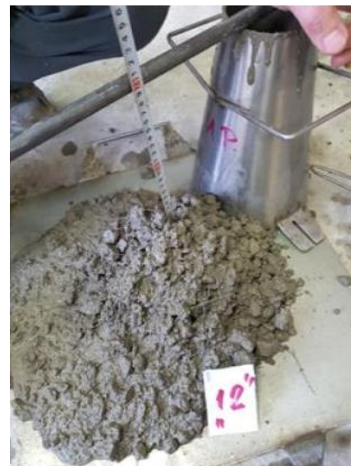
Снимка 14. „12“ DCP PC 130, Слягане s = 19,0 cm; w/c = 0,536 , водоотделяне
