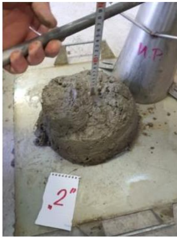
Снимка 3. и 4., 2“ CRYSO Fluid Optisol 30, Слягане s = 17,0 cm; w/c = 0,507 , въздухоотделяне
