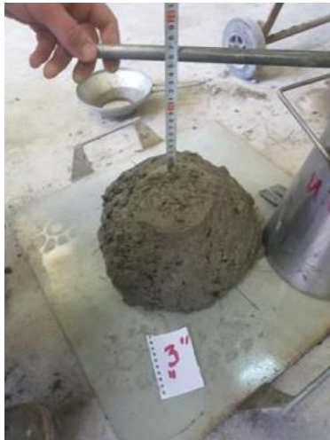
Снимка 5. „3“ BASF MasterGleniumSky 691; Слягане s = 16,0 cm; w/c = 0,523
