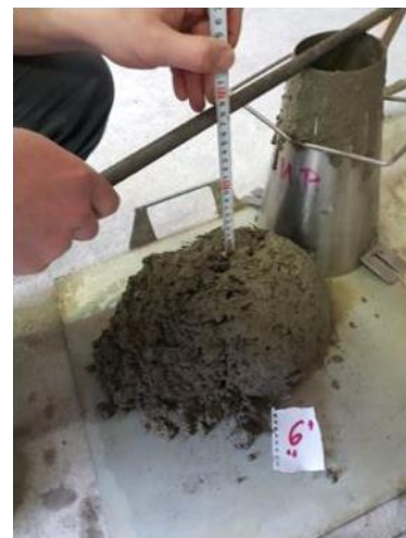
Снимка 8. „6“ MC Power Flow 5695; Слягане s = 17,0 cm; w/c = 0,523
