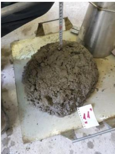
Снимка 13. „11“ - SIKA Viscocrete 1020 X; Слягане s = 20,0 cm; w/c = 0,536
