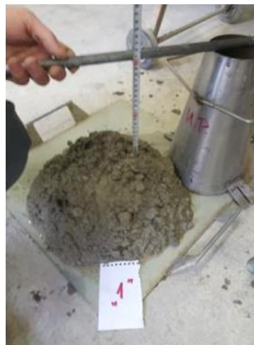
Снимка 2. „1“ KRYSTALINE Polidex, Слягане s = 20,0 cm; w/c = 0,483 , водоотделяне, светло кафяв бетон
