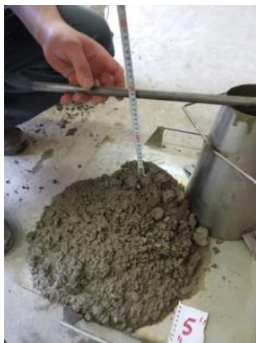
Снимка 7. „5“ MAPEI Dynamon SX 14; Слягане s = 18,0 cm; w/c = 0,500
