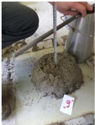
Снимка 11. „9“ ADING Superfluid AM; Слягане s = 20,0 cm; w/c = 0,512
