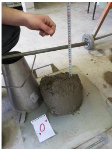
Снимка 1. „0“ контрола, Слягане s = 16,5 cm; w/c = 0,680
