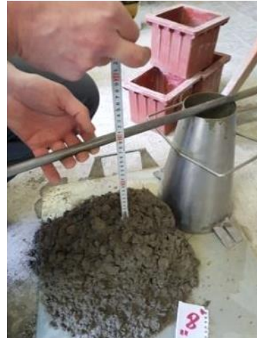
Снимка 10. „8“ SIKA Plast 175 S; Слягане s = 19,0 cm; w/c = 0,548
