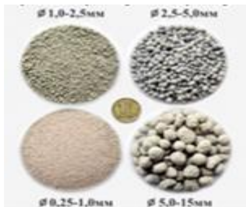
Фигура 1. Лабораторни образци на гранули от минерали на Черноморския басейн
