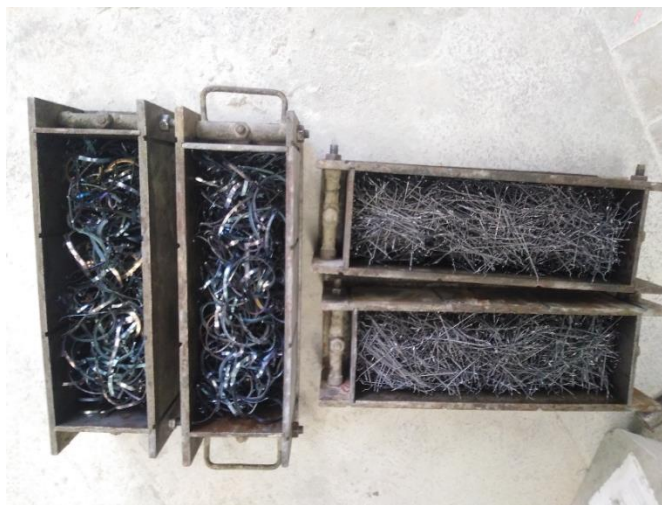
Фигура 2. Подготвена дисперсна армировка на SIFCON
