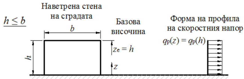
Фигура 2. Базова височина на z_e в зависимост от размерите на h и b и от профила на съответния скоростен напор при h \leq b [9]
