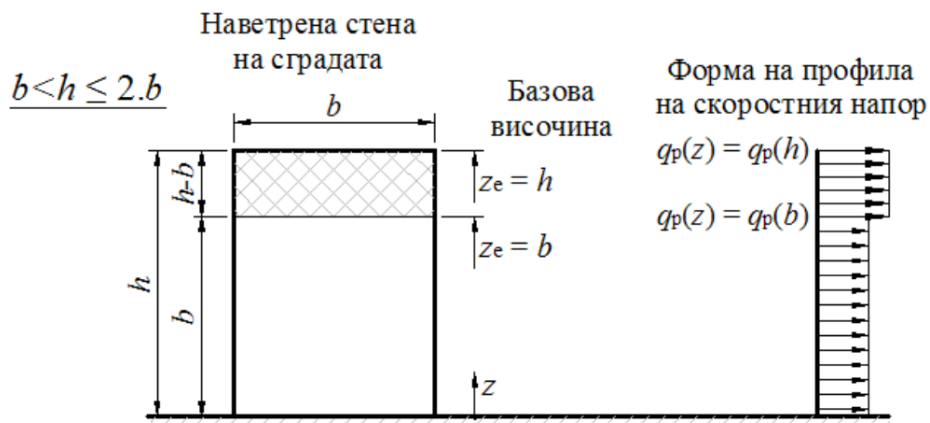
Фигура 3. Базова височина на z_e в зависимост от размерите на h и b и от профила на съответния скоростен напор при b < h \leq 2b [9]
