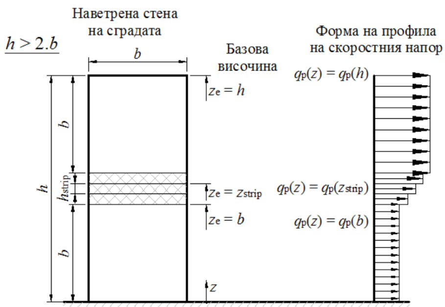
Фигура 4. Базова височина на z_e в зависимост от размерите на h и b и от профила на съответния скоростен напор при h > 2b [9]
