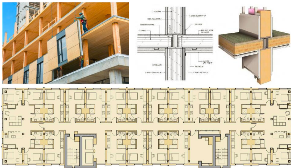
Фигура 3. Студентско общежитие Brock Commons – университет Британска Колумбия. Използвани са „...фабрично изработени елементи – подове, стени и колони, сглобени на място“. Отделните жилищни единици са разположени около комуникационен коридор, образувайки линейна пространствена структура [9, 10].
