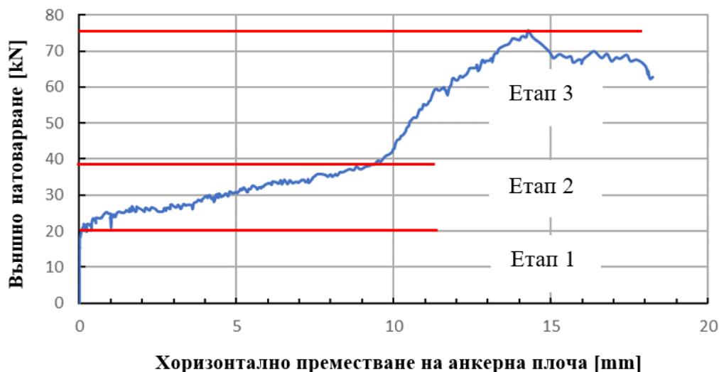
Фиг. 5. Хоризонтално преместване на анкерна плоча в зависимост от приложена сила
