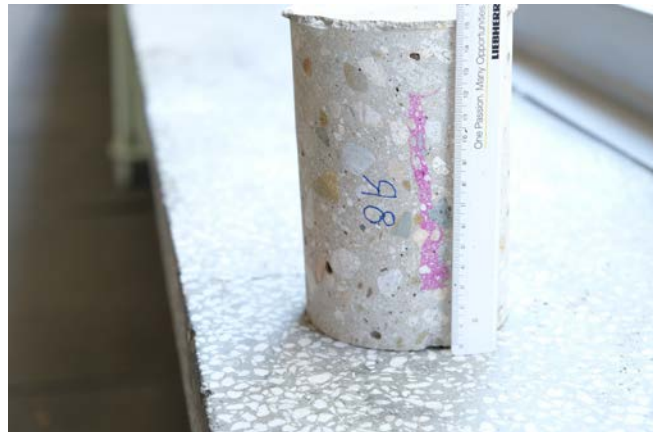
Фотография 3. Проверка на дълбочина на карбонизация на бетона с фенолфталеин
