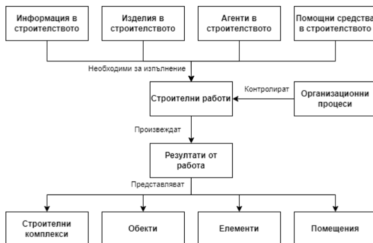
Фигура 2. Логически модел на ISO 12006-2, описващ взаимовръзките между обекти и процеси в строителството
