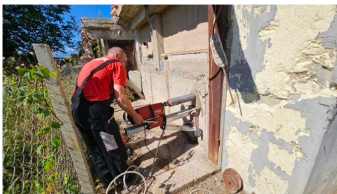
Фигура 1а и 1б Изрязване на сондажни ядки от конструкциите за определяне на възрастта на бетона
