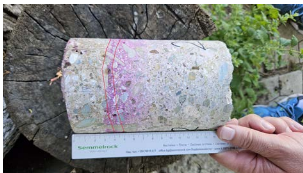
Фигура 2а и 2б Измерване на дълбочината на карбонизация на бетона, Легенда 1- външна повърхност; 2 - без промяна на цвета (с карбонизация); 3 - червено-лилав цвят (без карбонизация); А - d_{k,mean} ; В - d_{k,max}
