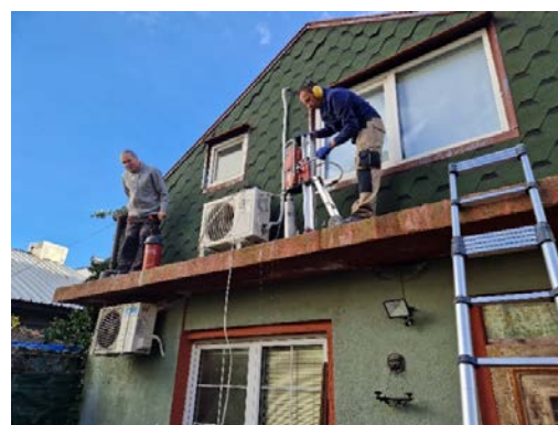
Фигура 1а и 1б Изрязване на сондажни ядки от конструкциите за определяне на възрастта на бетона
